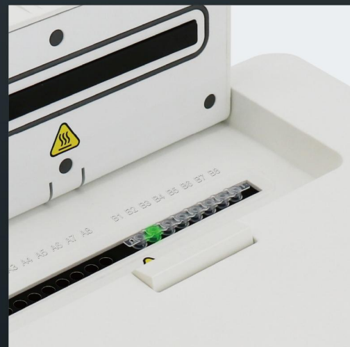
荧光检测中 (实际检测时，应关闭热盖)
