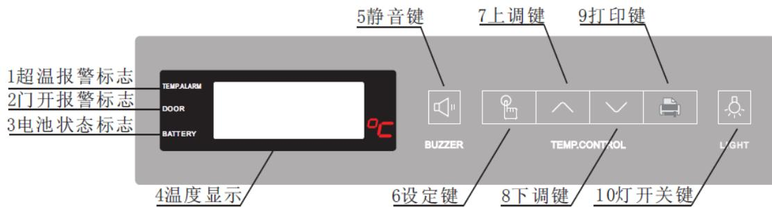
1-高温报警标志；2-门开报警标志；3-电池状态标志；4-柜内温度显示；5-静音键；6-设定键；7-上调键；8-下调键；9-打印键；10-灯开关键。
