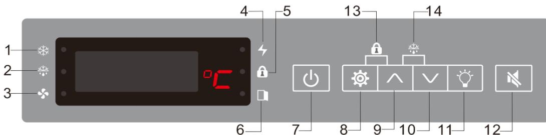
1-制冷状态标志；2-除霜状态标志；3-风机状态标志；4-电源状态标志；5-键盘锁；6-门开关状态标志；7-电源键；8-设定键；9-上调键；10-下调键；11-灯开关键；12-静音键；13-键盘锁键；14-化霜键。
